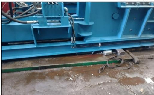
Fotografía 9. Derrame de aceite en placa de concreto
